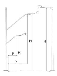
P: Pendor do ponto de luz H: Altura do ponto de luz I: Ângulo de inclinação (Incl. Braço + Incl. Luminária)
